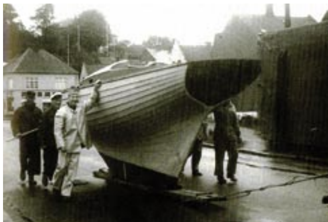
Billedet af transporten er taget på Lerchesvej, med Ørkildsgade i baggrunden. Det var en gammel Scania lastbil, der trak. Der blev ikke brugt ruller, men en tretommer bølgeplanke, der blev fornyet, når den blev for tynd, og der var ingen smørelse.
